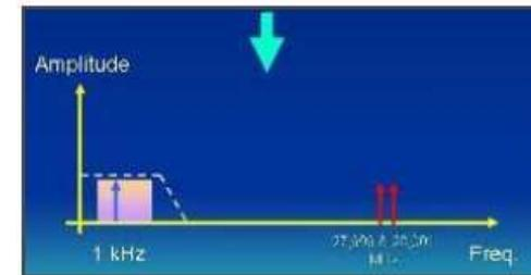
La suppression de la fréquence image passe par l'utilisation de la **Quadrature I & Q**. C'est ensuite le logiciel qui va l'éliminer. Ce sera d'autant plus facile pour lui qu'il verra à l'entrée de la carte son deux signaux identiques, d'amplitudes égales et déphasés rigoureusement de  $90^\circ$ .
